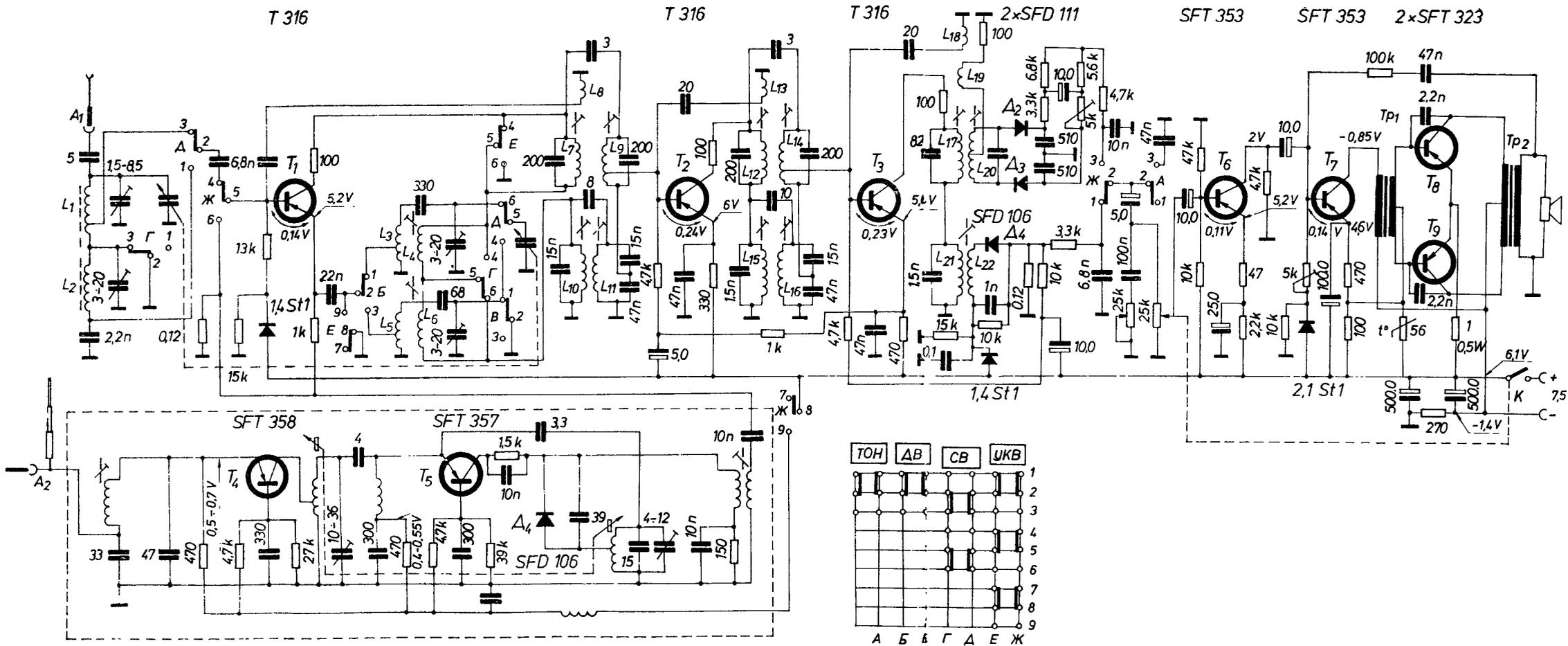
Фиг. 4.39. Принцилна схема на радиоприемник „Перла“
